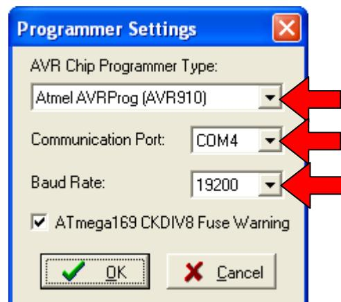
Le programmeur se sélectionne dans le menu obtenu en accédant à "Tools / Chip Programmer".
