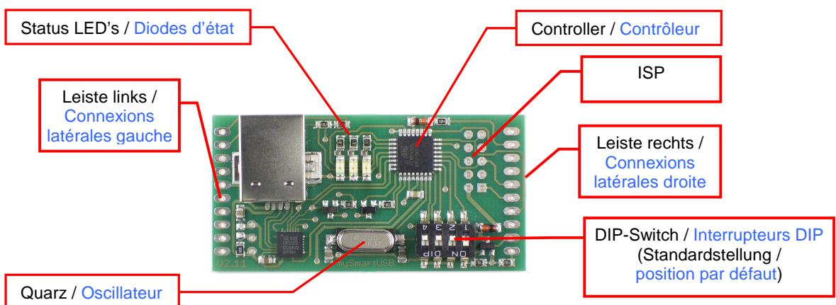
**DIP-Schalter und Betriebsmodi / Interrupteurs DIP et Modes de fonctionnement****Standardeinstellung der DIP-Schalter / Configuration par défaut des interrupteurs DIP**
