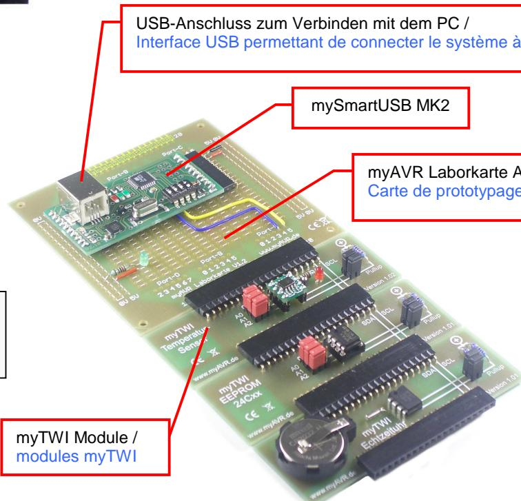
USB-Anschluss zum Verbinden mit dem PC /
