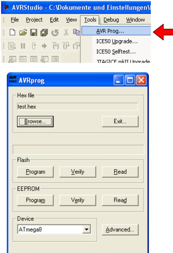
„AVR-Prog“ sucht standardmäßig nur an den COM-Ports 1 bis 4. Sollte der virtuelle COM-Port des mySmartUSB MK2 höher liegen findet das AVR Studio den Programmer nicht. In dem Fall muss über die Systemsteuerung ein für das AVR-Studio gültiger COM-Port zugewiesen werden. Dazu benötigen Sie Administratorrechte.
